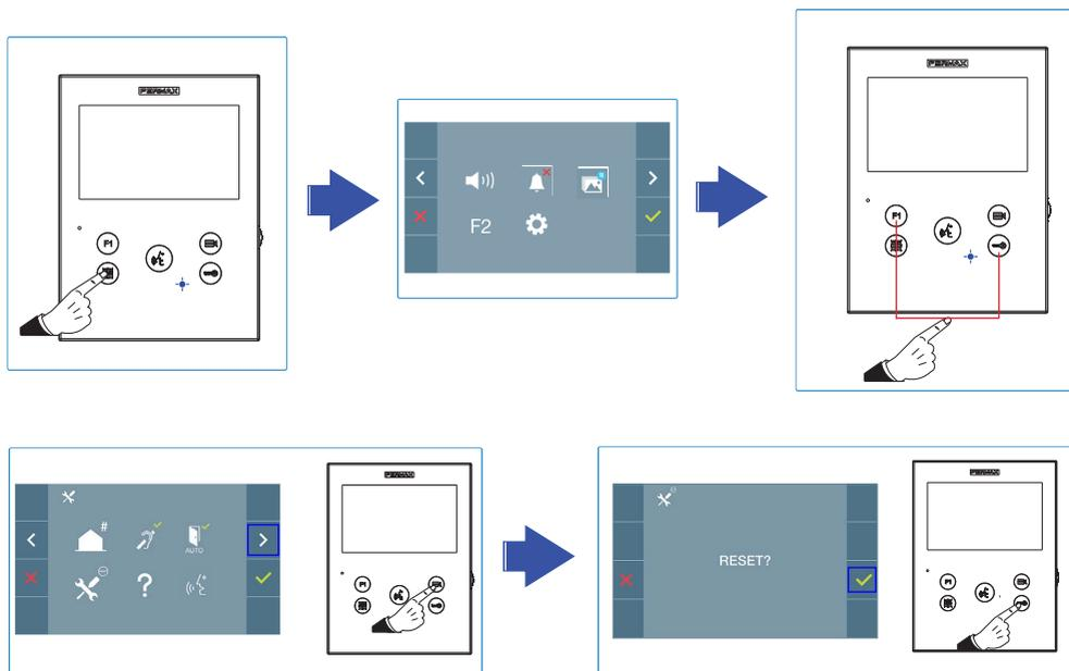
**Hinweis:** Die Rückstellung löscht die programmierte Adresse. Die blinkende LED zeigt an, dass die Rückstellung ausgeführt ist.
