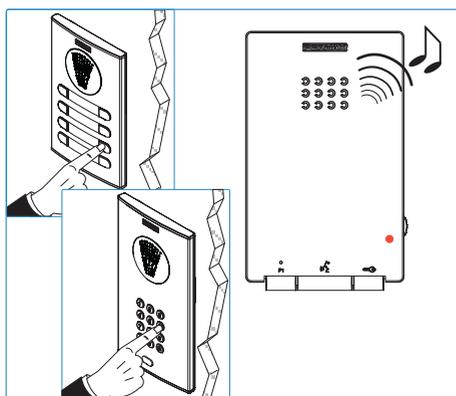
**Hinweis:** Die Zeit, die vom Moment des Öffnens des Programmiermodus des Telefons (Signalton) bis zum Anruf über die Türstation an das Telefon zur Programmierung der Telefon-Adresse vergehen darf, liegt bei 2 Minuten 30 Sekunden.
