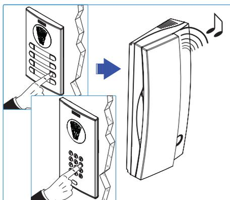
**Hinweis:** Das Telefon funktioniert erst dann, wenn es programmiert worden ist. Zur Programmierung muss zuerst die Türstation als Master konfiguriert werden.
