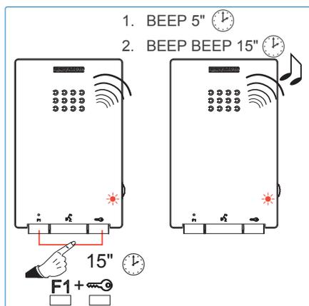
**Hinweis:** Die Rückstellung löscht die programmierte Adresse. Die blinkende LED zeigt an, dass die Rückstellung ausgeführt ist.
